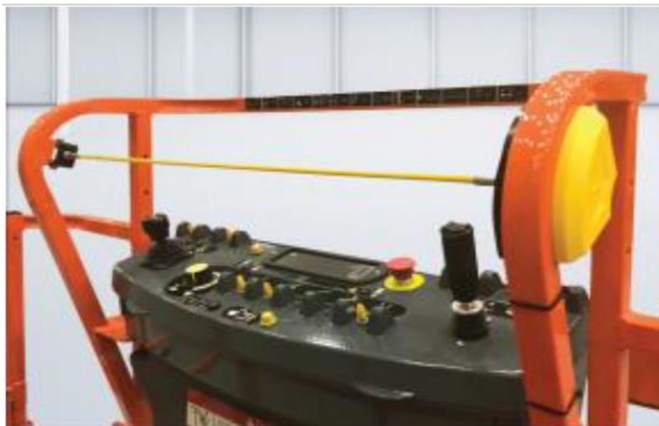
Ejemplo de sistema antiatrapamiento con dispositivo de detección de presión (SkyGuard® SkyBar –JLG)
