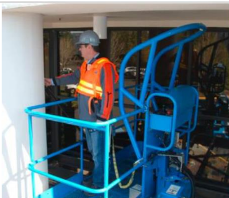
Ejemplo de sistema antiatrapamiento con barreras físicas
